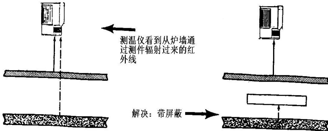
低于100℃时，测温可自动地修正反射造成的误差。
